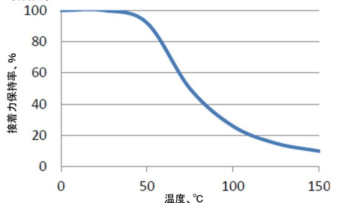
本データは軟鋼同士の剪断強度の温度依存性です。完全硬化した後、各設定温度で 30 分放置してから引張試験を実施したものです。
