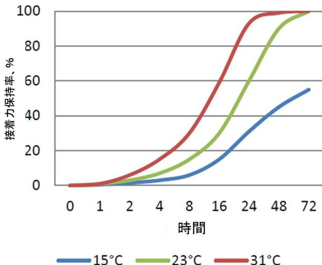
本グラフは部材間の接着力の時間変化を示しています。8°C間隔の3通りの温度での硬化時間の違いがわかりません。温度が低いと硬化は遅くなります。
