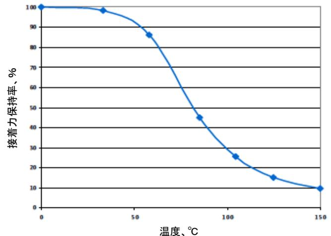
ET510 は、接合部に急激なストレスがかからない限り、焼き付け塗装やフローハンダ工程などの短時間での高温状態も接着力は保持されます。硬化後の最低温度は、被接着材料により-40°Cまで可能です。
