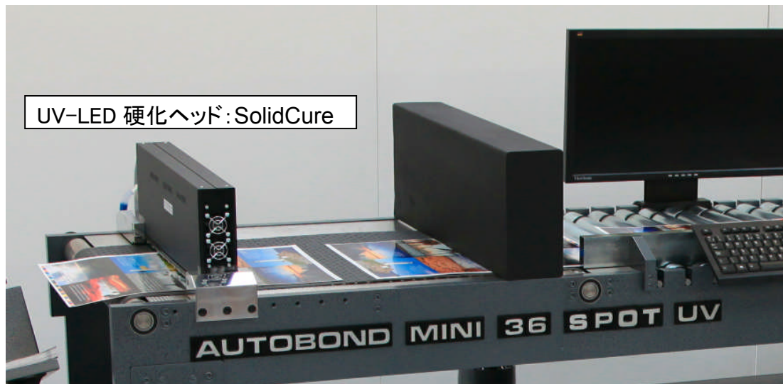
図9 UV ラミネータへの SolidCure 適用例 (LED アレイ長 400mm)
