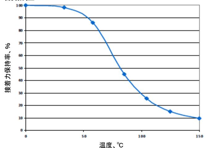
ET536 は、接合部に急激なストレスがかからない限り、焼き付け塗装やフローハンダ工程などの短時間で高温状態も接着力は保持されます。硬化後の最低温度は、被接着材料により-40°Cまで可能です。
